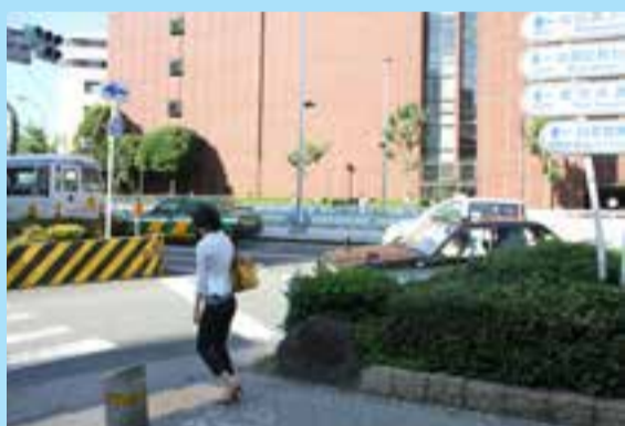
歩道の植え込みは90cm程度の高さがあり、タクシーなど車高の低いクルマのドライバーは横断歩道に近づく歩行者を発見しにくい
