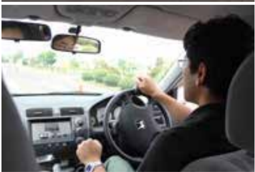
実技の1つハンドル操作を教習指導員が体験。ジグザグに配置されたパイロンの間を5km/hを維持しながら走行する。左手でブレーキとアクセルを操作している
