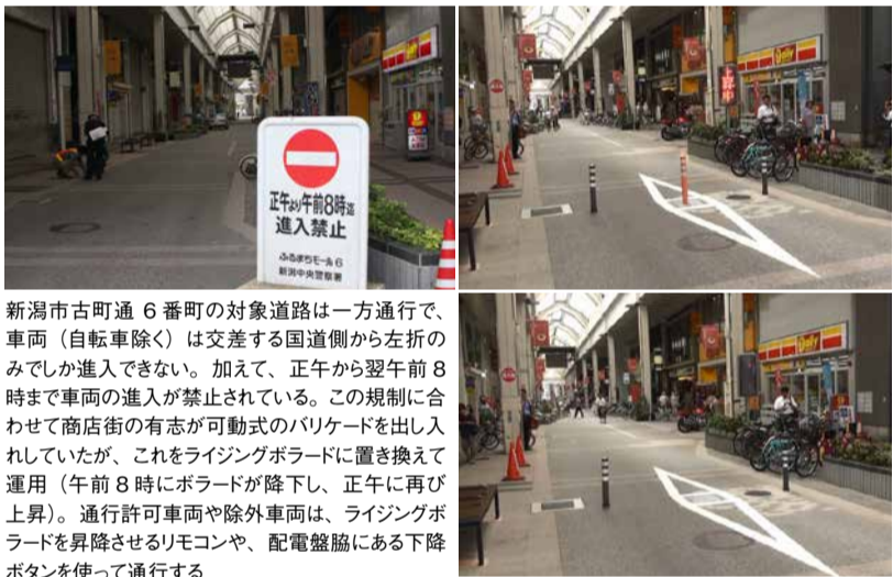
新潟市古町通6番町の対象道路は一方通行で、車両（自転車除く）は交差する国道側から左折のみでしか進入できない。加えて、正午から翌午前8時まで車両の進入が禁止されている。この規制に合わせて商店街の有志が可動式のバリケードを出し入れていたが、これをライジングボラードに置き換えて運用（午前8時にボラードが降下し、正午に再び上昇）。通行許可車両や除外車両は、ライジングボラードを昇降させるリモコンや、配電盤にある下降ボタンを使って通行する
