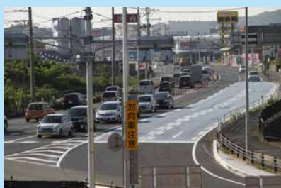
直進が優先となるように車線を整理(改良前、直進車は左折レーンから直進レーンへの車線変更が必要だった)
