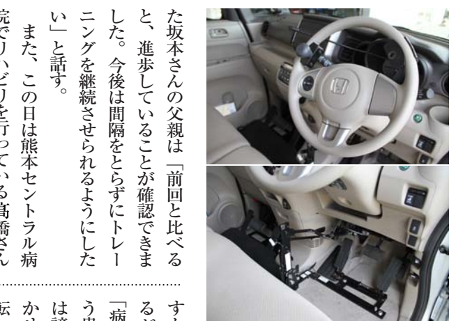
トレーニング車両に取り付けられた左手・左足で操作するための運転補助装置
