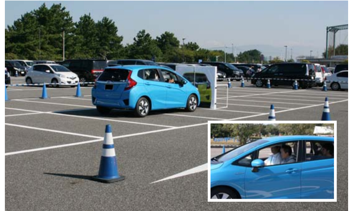
CTBAは、約30km/h以下での前方車両との衝突の回避・軽減を低速域衝突軽減ブレーキで支援。前方に障害物がある状況で、アクセルペダルを踏み込んだ場合に、急な発進を抑制する誤発進抑制機能(MT車を除く)も備えている。このCTBAをドライバーに正しく理解してもらうための安全運転教育プログラムを開発中
