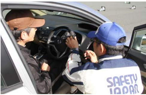
ハンドル操作がスムーズにできるよう旋回ノブを取り付ける
