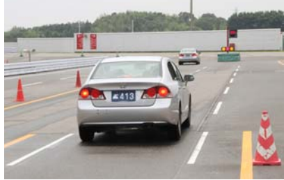
40km/hで走行し、正面にある信号の点灯を確認したら急ブレーキをかける反応制動。お客様を乗せている時、急ブレーキを使わないようにするため、安全な車間距離(車間時間)をどのようにとるべきか考えてもらう
