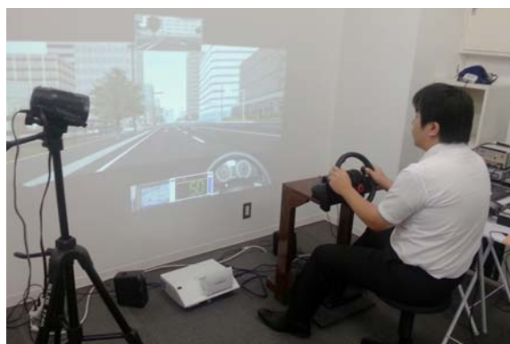
Sナビを使って後期緑内障患者の運転データを収集
