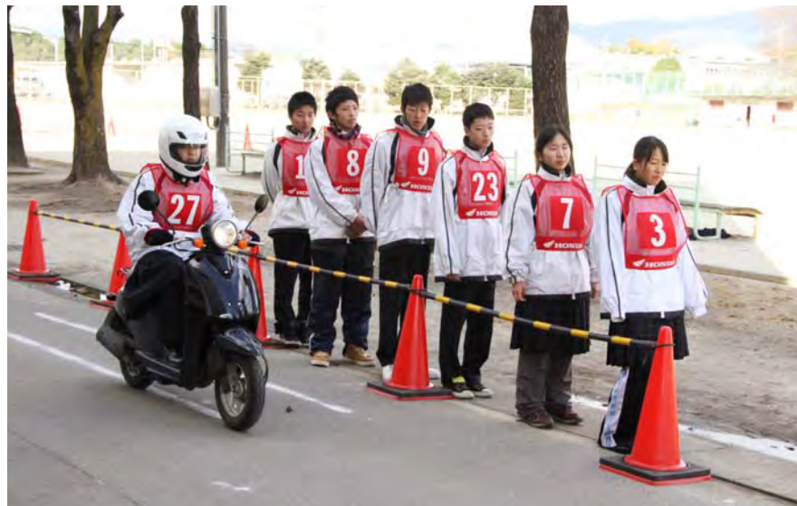
1列に並んだ歩行者の真横を生徒が運転する原付が30km/hで走る。1回目は歩行者と約1mの間隔(写真下)、2回目は約1.5mの間隔(写真上)をとる
