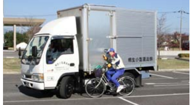
トラックの内輪差による巻き込み事故の再現
