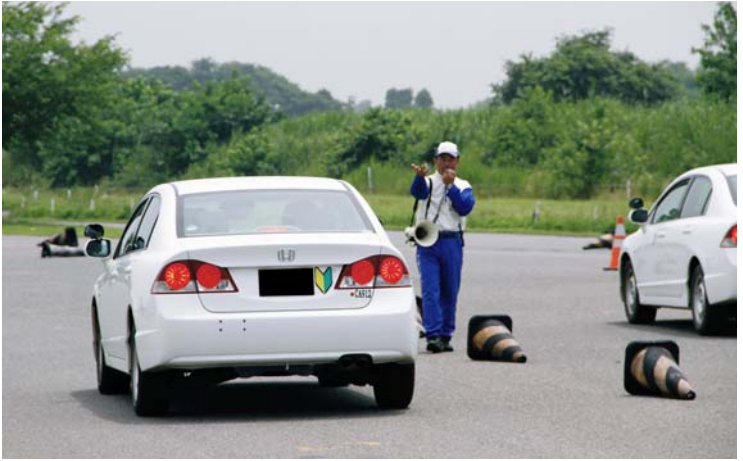
50km/hから80km/hの速度で、ABSが作動するまでブレーキペダルをしっかりと踏み続けるトレーニングを行った
