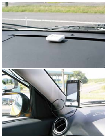
車内に取り付けしたGPSアンテナ(写真上)とデータを収集するためのPDA(携帯情報端末)。取り外しが可能なので、どの車両にも対応できる
