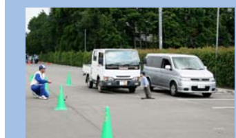
①歩行者の飛び出し実験 30km/hで走るクルマの前に駐車車両のカゲからダミー人形が飛び出し、どんなに運転が上手なドライバーでも急な飛び出しには対応できないことを伝える。
