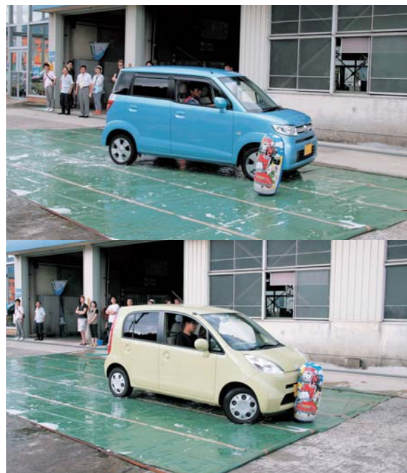
参加者にビニール製の障害物に向かって急ブレーキをかけてもらう。ABSの搭載されているクルマはハンドルをきった方向に曲がる(写真上)。ABSのないクルマはハンドルをきいてもまっすぐにすべって障害物に衝突する(写真下)
