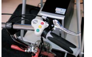
発進は、右後方にあるボールの先のランプの色を確認して、ハンドル部分にある同じ色のボタンを押してから走り出す
