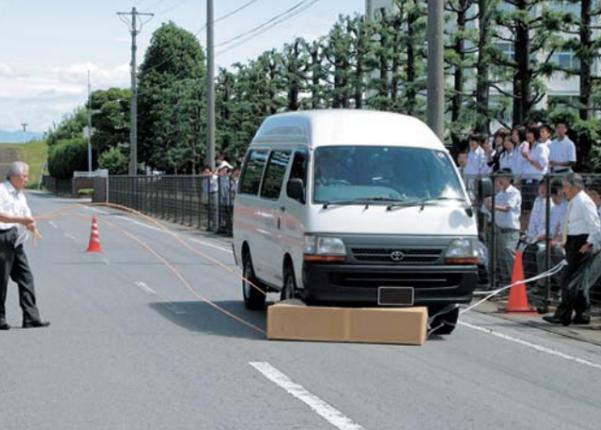
自転車に見立てたダンボール箱を、50km/hで走ってくるクルマの前に飛び出させた模擬衝突実験
