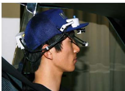
シミュレーターを運転する被験者の視線の移動をアイマークレコーダーで測定
