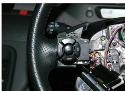
開発中のステアリングスイッチはハンドルを握る親指で操作できるスイッチ。写真は5つボタンのタイプ
