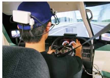
テーマ1「車載向け新ヒューマン・インターフェースの評価」の実験風景。音声指示に従い、ダッシュボード上に設置されたヘッドアップディスプレイ(HUD)を見ながら、ステアリングスイッチでオーディオやエアコンを操作する
