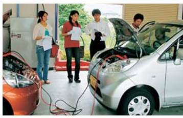
バッテリーがあがってしまった時に応急処置ができるように、ブースターケーブルのつなぎ方を確認
