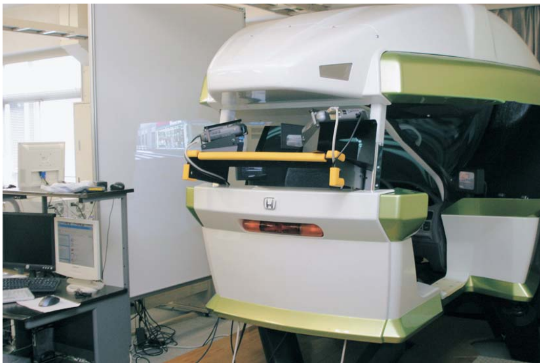
芝浦工業大学の古川教授はシミュレーターの左右にスクリーンを置き、シミュレーター本体の後部のプロジェクターから画像を投影することで、ドライバーの真横の景色を再現
