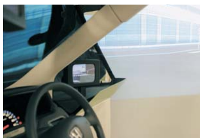
芝浦工業大学の古川教授はシミュレーターの左右にスクリーンを置き、シミュレーター本体の後部のプロジェクターから画像を投影することで、ドライバーの真横の景色を再現
