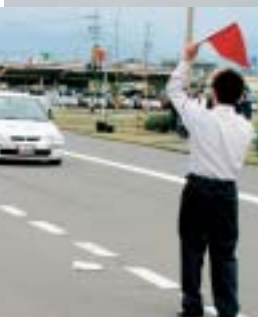
写真下 / 約20km/hの速度で自転車とクルマが併走し、旗の合図とともにブレーキをかけ、その停止距離を比較
