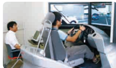
「Hondaドライビングシミュレーター」は従来の6軸に加え、コンパクト設計の2軸モーションタイプを用意
