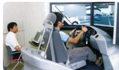
「Hondaドライビングシミュレーター」は従来の6軸に加え、コンパクト設計の2軸モーションタイプを用意
