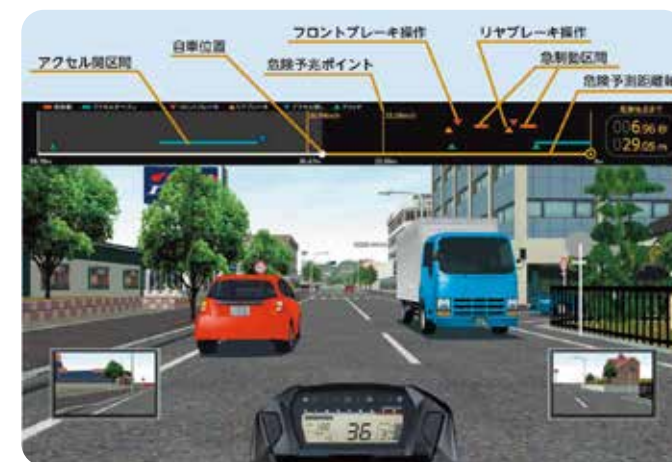
「危険予測表示機能」で走行時の操作を記録（画面はイメージ） ※平成28年4月15日 特許登録（特許第5919243号）
