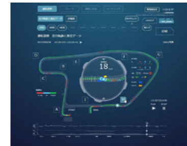
アクセルやブレーキ、ウィンカーの操作状況、加減速時などに発生する G（加速度）、コースの走行軌跡を測定したデータと客観 VS 自己評価が比較された評価表を配布（1 回目）
