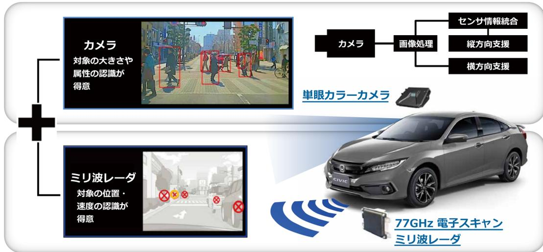
ミリ波レーダは、認識対象の距離・速度を計測することが得意である特性に加え、従来、反射量が小さく同センサでの検出が難しかった歩行者など、認識対象を拡大。カメラは、前方約60mの距離での対象の大きさや属性を、高い精度での認識を実現。
