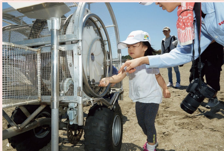
1 自分たちでゴミを拾い、ふかふかになった綺麗な砂浜を素足で歩く喜びはひとしお。2 クリーン後のレクリエーションも楽しい。3 大きなゴミを人の手で拾った後、ATVに取り付けたサンドレーキ(熊手)で砂を掘り起こして中型のゴミを集め、さらに細かいゴミをサンドスクリーン(振るい)にかけて集める。4 通称「ぐるぐる」は、濡れたゴミと砂を別ける作業を軽減。5 集めたゴミを分別する「ゴミ回収ステーション」。
