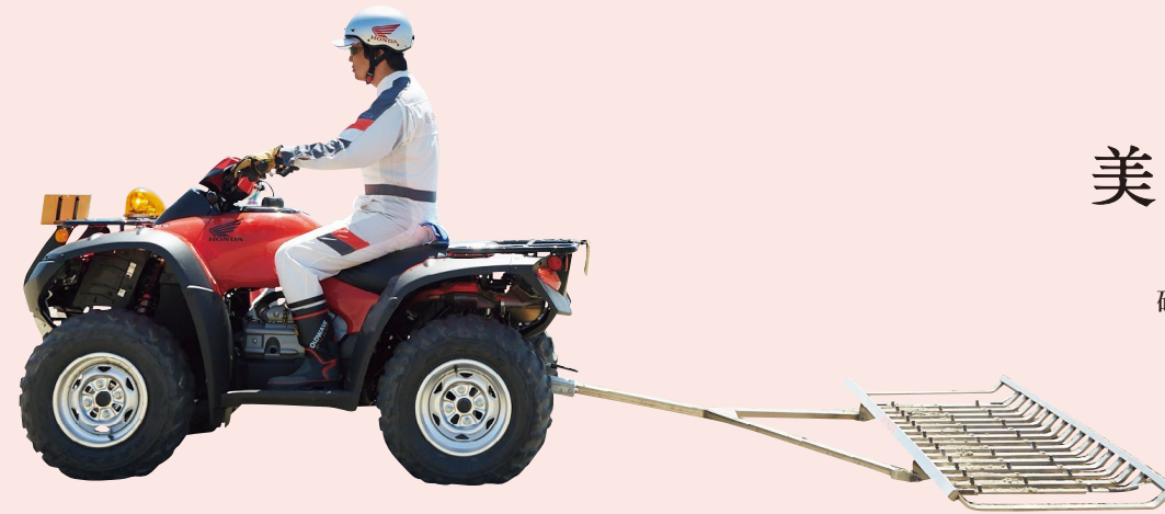
1 自分たちでゴミを拾い、ふかふかになった綺麗な砂浜を素足で歩く喜びはひとしお。2 クリーン後のレクリエーションも楽しい。3 大きなゴミを人の手で拾った後、ATVに取り付けたサンドレーキ(熊手)で砂を掘り起こして中型のゴミを集め、さらに細かいゴミをサンドスクリーン(振るい)にかけて集める。4 通称「ぐるぐる」は、濡れたゴミと砂を別ける作業を軽減。5 集めたゴミを分別する「ゴミ回収ステーション」。
