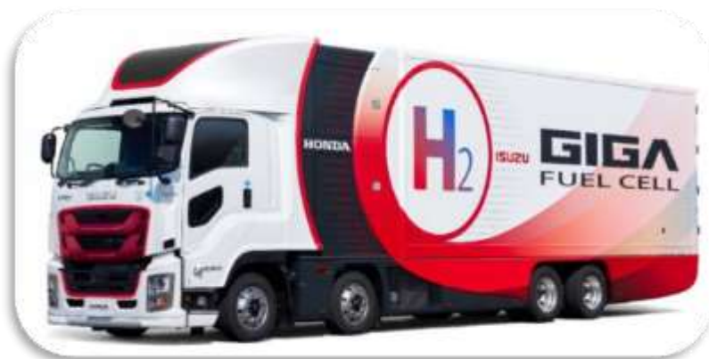
いすゞ・Honda共同研究車両 「GIGA FUEL CELL」
