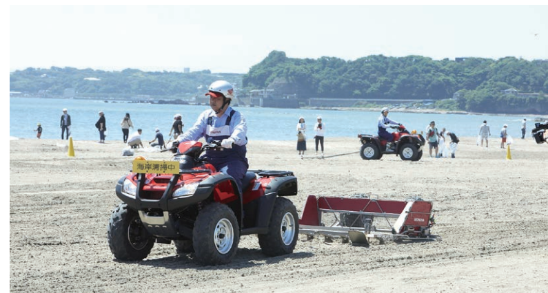
砂中のゴミを掘り起し回収できるビーチクリーナー
