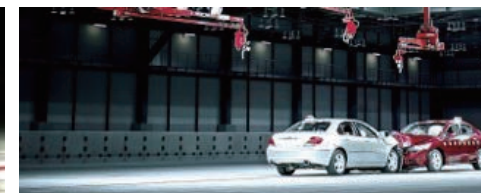
屋内型 全方位衝突実験施設
