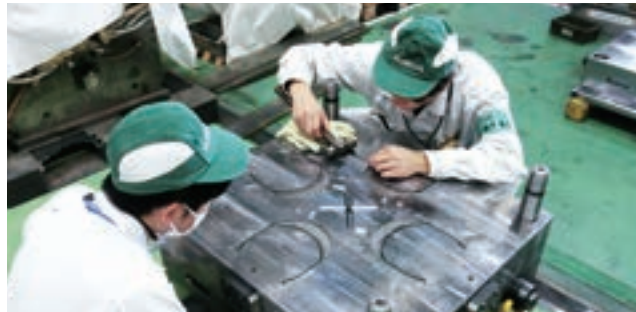
金型開発の知識を活かし、フェイスシールド用バイザーの金型を製作
