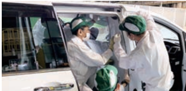
感染者搬送用の車両に仕切りをセット。隙間を無くす合わせ込みが難しい
