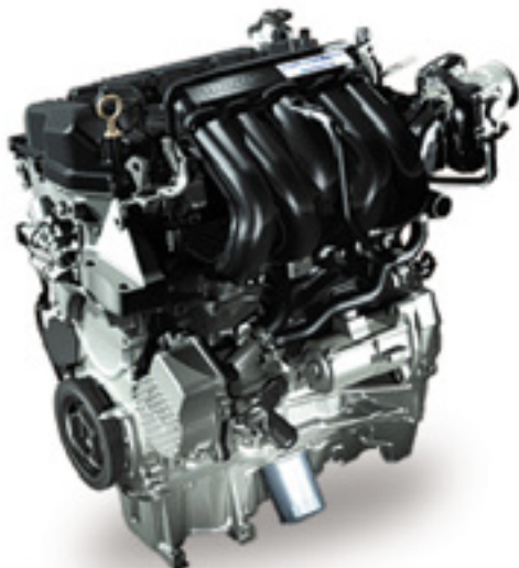
新ハイブリッドシステム「SPORT HYBRID(スポーツ ハイブリッド) i-DCD」のエンジン、1.5L アトキンソンサイクル DOHC i-VTEC
