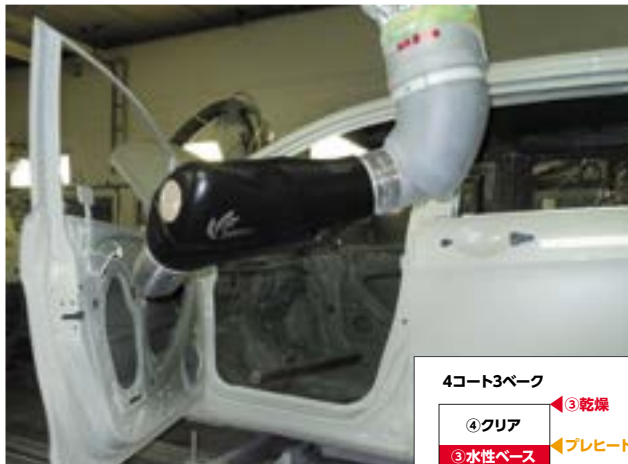
(右図) 図の左側が従来型の塗装工程(4コート3ベーク)、 右側が新開発の塗装工程(3コート2ベーク)。 従来の中塗工程を省略することで工程を短く、 エネルギー使用量も大幅に削減
