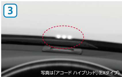
写真は「アコード ハイブリッド」(EXタイプ) メーター内表示による警告に加え、ダッシュボード 前方のヘッドアップワーニングによる警告を実施
