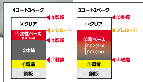
(右図) 図の左側が従来型の塗装工程(4コート3ベーク)、 右側が新開発の塗装工程(3コート2ベーク)。 従来の中塗工程を省略することで工程を短く、 エネルギー使用量も大幅に削減
