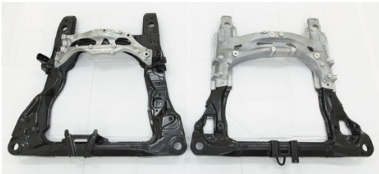
(左)従来のフロントサブフレーム (右)FSW技術で生産したフロントサブフレーム
