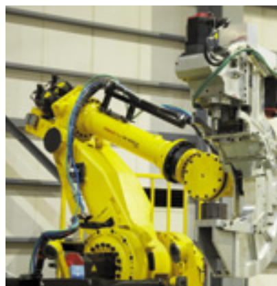
(左) フロントサブフレームの位置。ピンクの部分FSW接合部 (右) FSW技術用の「高剛性Cガンアーム」。装置の小型化により生産ラインでのFSW接合を実現しています
