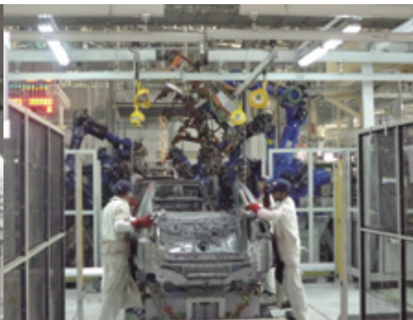
各工程でHondaのクルマづくりのノウハウが活かされている。写真は溶接工程
