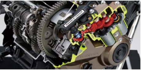
二輪車向けの電子制御クラッチ技術「E-Clutch」
