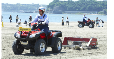
砂中のゴミを振り起こし回収できるビーチクリーナー
