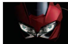
LEDの採用により、省電力化に加え、視認性、被視認性の向上、耐久性の向上、部品のコンパクト化、デザイン性の向上も同時に達成
