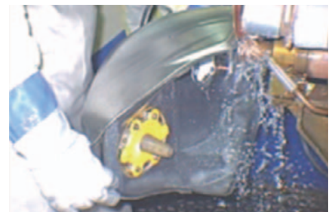
ローラー状の2つの電極の間に材料を挟み、加圧・通電しながら溶接
