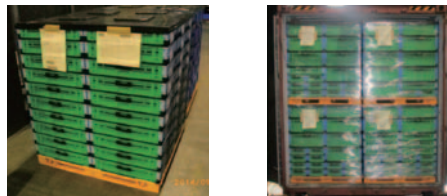
内装のリターナブル容器を活かし、段ボールとスチールケースを廃止。これにより、コンテナ積載量の増加(61m 3 ⇒65m 3 )を実現
