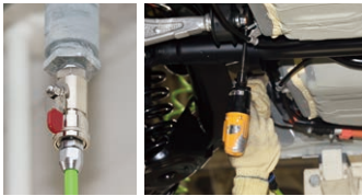
圧力損失の少ないホースジョイント(左)と、圧縮エアを使った組み付け作業(右)
