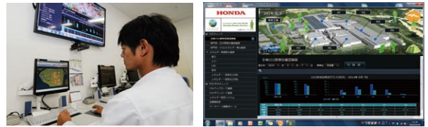
FEMSで工場全体のエネルギーを一括マネジメント(右はFEMS管理画面)
