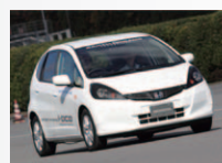
新開発1モーターハイブリッドシステム「i-DCD」を搭載した試作車(左)と、「SPORT HYBRID SH-AWD」を搭載した試作車(右)
