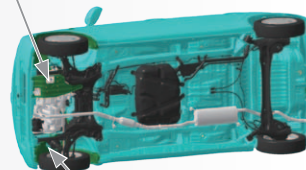
車外へのエンジン音を遮断するフロントインナーフェンダーインシュレーター
