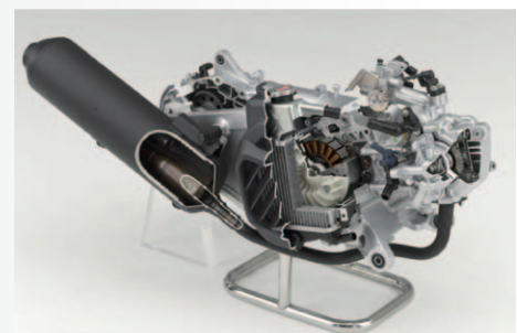
消耗品の使用量軽減に取り組んだ次世代小型スクーター用エンジンeSP
