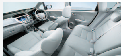
「バイオPET」表皮をシートやドアライニングに採用した「フィットEV」のインテリア
