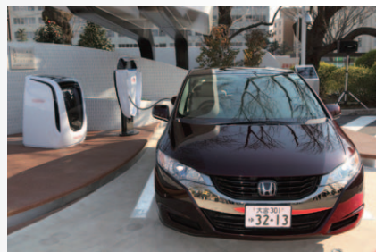
埼玉県庁南玄関前に設置されたソーラー水素ステーションから水素供給を受ける燃料電池電気自動車「FCXクラリティ」
