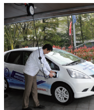
手の汚れない吊り下げ式充電設備
