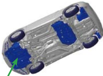
エンジンルームアンダーカバー 車外へのエンジン音を遮断
