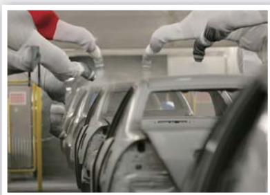
メアリズビル四輪車工場の塗装ラインでは 化学物質の少ない水性コーティング剤を利用
