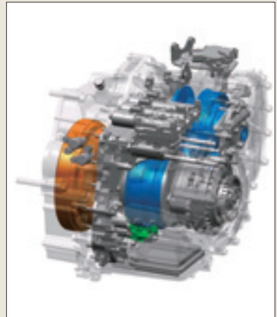
トルクコンバーター付きCVT構造図
