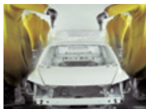
ボディ上塗り塗装ロボット
