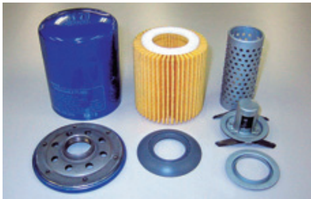
分解されリサイクルされる使用済みオイルフィルター
