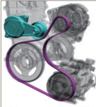
補機ベルト駆動システム構造図
