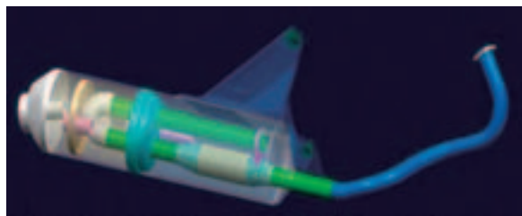
排気音低減 3室構造サイレンサー
