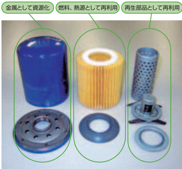
分解されリサイクルされる使用済みオイルフィルター
