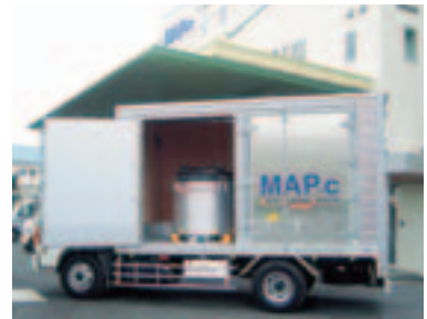
アルミ再生合金工場からアルミ溶湯を直接供給するトラック
