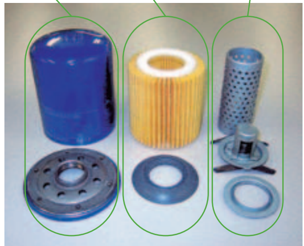
分解されリサイクルされる使用済みオイルフィルター
