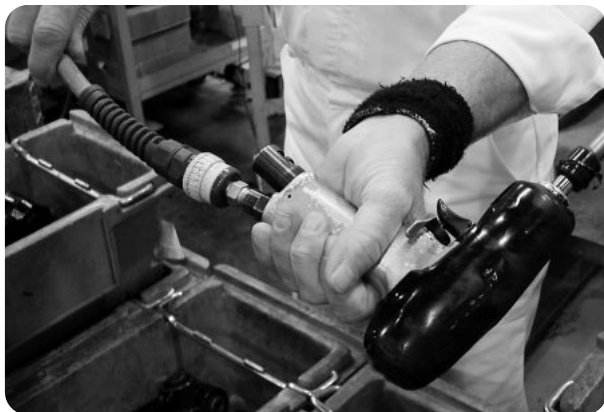
樹脂製に交換したインパクトレンチ接合部
