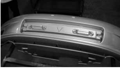
バック・ジグを使用したマスキング
