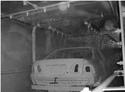
洗浄用シャワー吹き出し口改善後の塗装ブース
