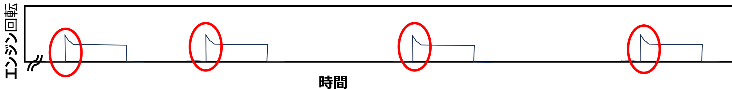
図 エコマイレージチャレンジの一般的な走行の模式化
