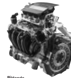
新Hondaハイブリッドシステム(3ステージi-VTEC+IMA)カットモデル New Honda Hybrid System (3-stage i-VTEC+IMA) cutaway model
