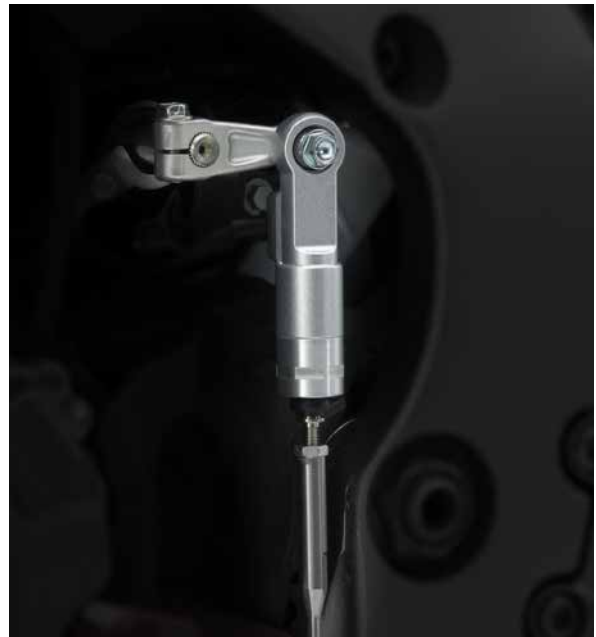
■CBR1000RR SP クイックシフター ストロークセンサー部
