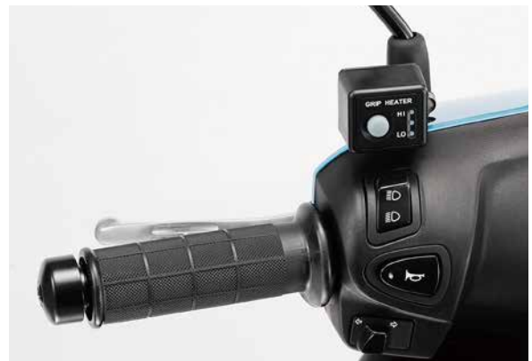
■グリップヒーター 発熱体に合金ステンレス鋼 (SUS) を採用した、Honda 独自の半周タイプグリップヒーターです。バッテリー電圧監視システムを内蔵し、バッテリーの電圧が低下した際にはグリップヒーターへの電源供給を自動的に中止します。5段階温度調整が可能。
