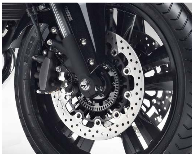
フロントφ310mmダブル大径ディスク、3ポットキャリパー
