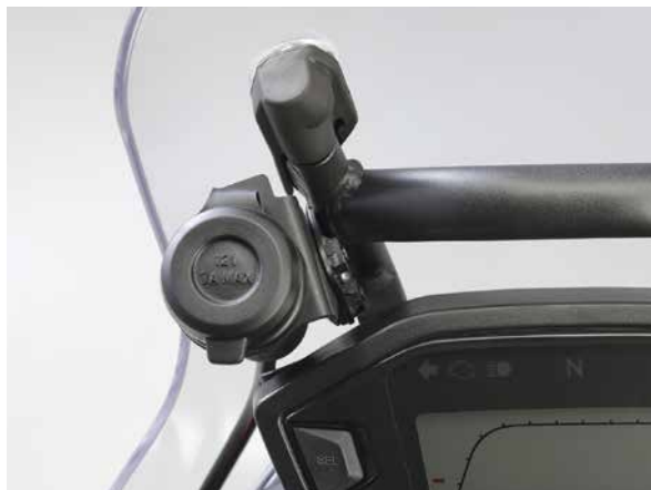
アクセサリソケット 定格36W (12V3A)まで使用できます。
